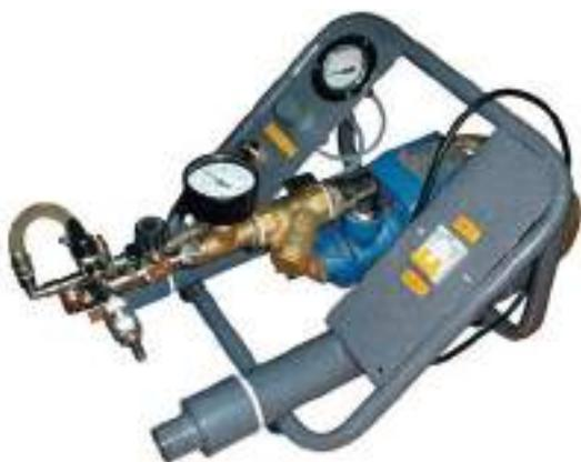
Пеногенератор ПЕНА-ПМГ применяется при изготовлении пенобетонных и других поризованных строительных смесей на цементном или цементно-известковом вяжущем, как в составе высокопроизводительных поризаторов непрерывного типа, так и для циклического приготовления пенобетона путем добавления пены в раствор-смеситель и последующего перемешивания.
