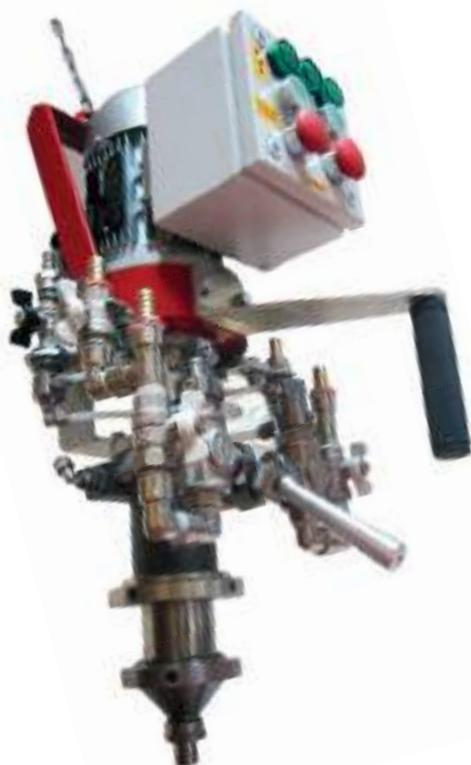
Для заливки пенополиуретана используют заливочный комплекс, представляющий собой установку ПЕНА-20, оснащенную специальным смесительным устройством – заливочная головка (ЗГ). ЗГ служит для гомогенного перемешивания компонентов А и Б посредством вращения миксера сложной формы. Для технологичности процесса заливки ППУ оборудование комплектуется пультом управления, который позволяет автоматизировать и контролировать время и массу впрыска композиции.
