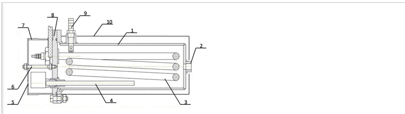
Подогреватель представляет собой цилиндрический корпус (1), с входным (9) и выходным (2) отверстиями, в котором размещены тэн (3) для подогрева воздуха и термостат (4) для регулировки температуры воздуха на выходе. Для изоляции контактов тэна с помощью шпильки (6) с торца агрегата крепится крышка (7).
